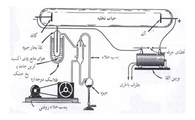
نموداری از دستگاه تخلیهٔ الکتریکی در گازها: شامل مدار الکتریکی و مدار خلاً
