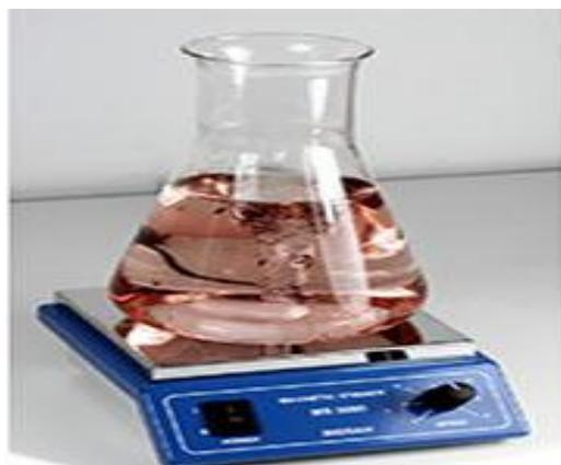
از آنجایی که میدان مغناطیسی، شیشه را تحت تأثیر قرار نمی دهد بیشتر لوازم آزمایشگاهی که از شیشه ساخته می شوند برای هم زدن مایعات به صورت یکنواخت ببروی دستگاه همزن مغناطیسی بسیار مناسب هستند. از سوی دیگر یکی از عیوب این دستگاه این است که چون اندازه صفحه چرخان و مگنتهای مورد استفاده برای همزدن محدود است، برای انجام آزمایش های نسبتاً کوچک (حداکثر تا ۵ لیتر) می توان از آن استفاده کرد. در واقع اگر حجم محلول زیاد باشد، مگنت توانایی مخلوط کردن این حجم را نخواهد داشت.
